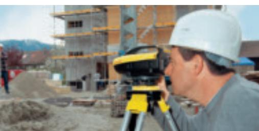
Control de elevación, transferencia de altura
