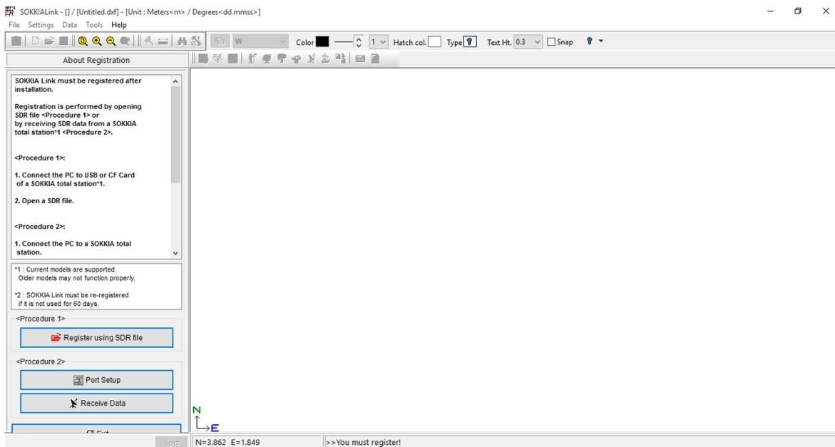
Se configura en la pestaña de *Port Setup* las mismas opciones que en la estación total, dar en “ok” para continuar.
