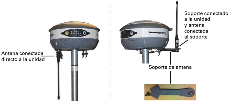
**Figura 2-2: Opciones de instalación de antena**
