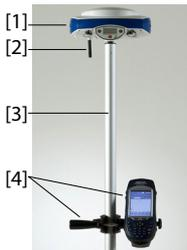
Como función estándar, el ProMark 500 incorpora un módem GSM integrado, lo que significa que sólo tiene que conectar la antena GSM si ha pagado la activación del hardware.
