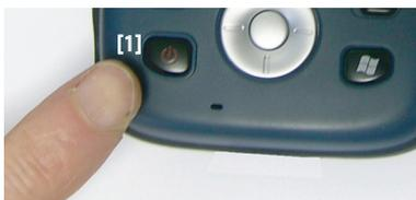
Deje que el receptor ejecute su secuencia de arranque. Espere hasta que aparezca la pantalla Casa de Windows Embedded Handheld. Llegados a este punto, es posible que se le pida que inicialice el receptor (alineación de pantalla, etc.). Sólo tiene que seguir las instrucciones en pantalla para completar este paso.
