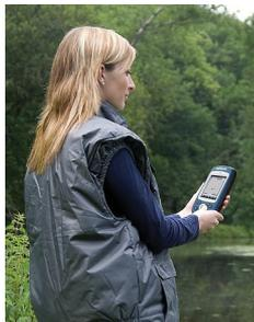
Para que su receptor pueda detectar satélites, tiene que estar en el exterior y debe sujetarlo de forma adecuada.
